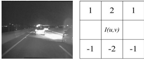
(a)原始影像 (b)水平 Sobel 遮罩
